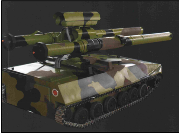
Слика 69 – Роботизовани систем МИЛИЦА са уграђеним двоструким лансером 90 mm M79 ОСА.
