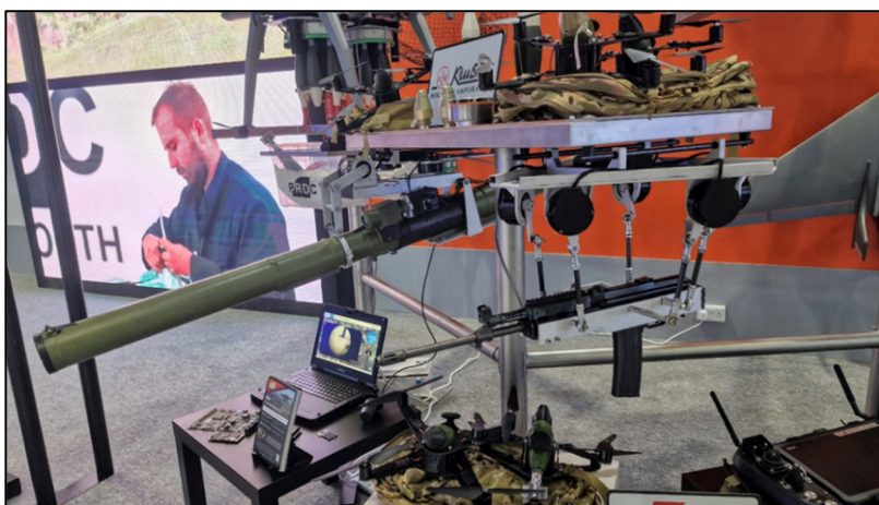
Слика 78 – Модуларни стабилизовани додаци за беспосадне летелице: Ракетни бацач 90 mm М79 ОСА и Заставина аутоматска пушка М21.
