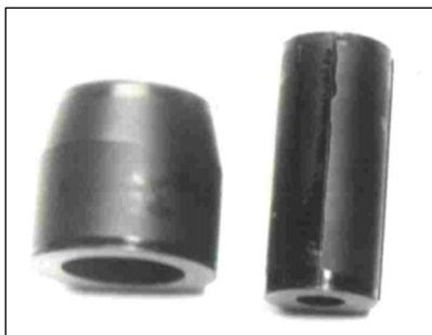
Слика 32 – Погонско пуњење додатног ракетног мотора.
