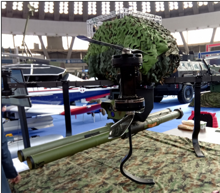
Слика 75 – Дрон ТРИФУН фирме „КОНЕЛЕК“ са два лансера РБР 90 mm М79 ОСА.
