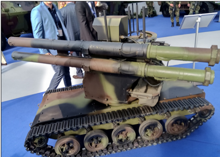
Слика 74 – Даљински контролисана беспосадна земаљска платформа, на којој су уграђени: митраљез 7,62 mm M86, бацач граната 40/6 mm и 2 лансера ОСЕ.
