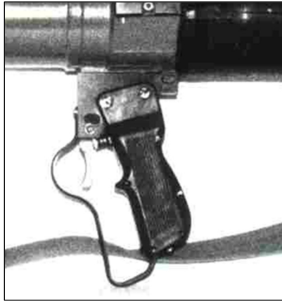
Слика 15 – Ручни електрични механизам за опаљивање на лансирном оружју.
