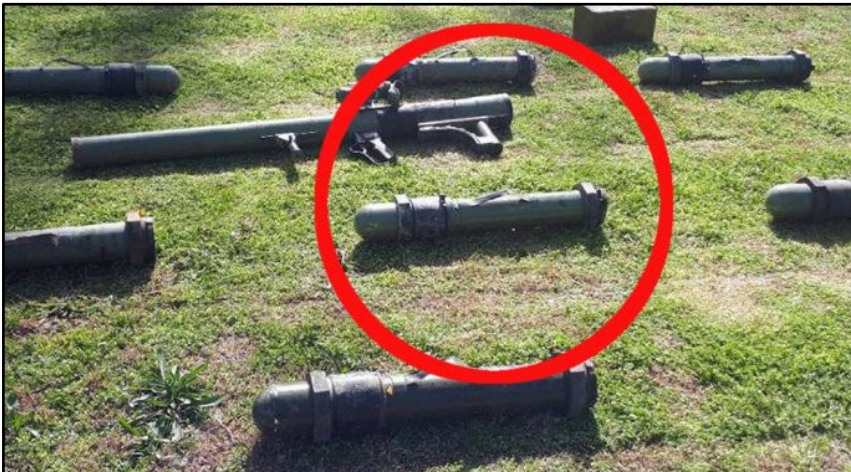
Слика 118 – Лансер и ракете ОСА у контејнерима које је Сиријска регуларна армија запленила од ИСИЛ-а (Наслон за раме на лансеру постављен погрешно)
