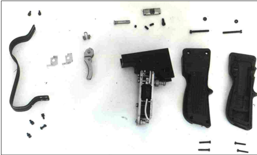
Слика 16 – Делови и подсклопови електричног механизма за опаљивање.
