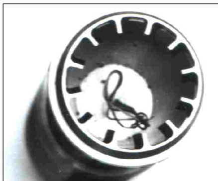
Слика 26 – Прстен са колом од 12 лопатица под углом на излазном делу млазника.
