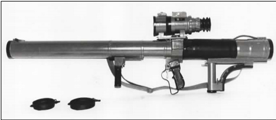
Слика 64 – Лансер 90 mm М79 ОСА са ноћним нишаном.
